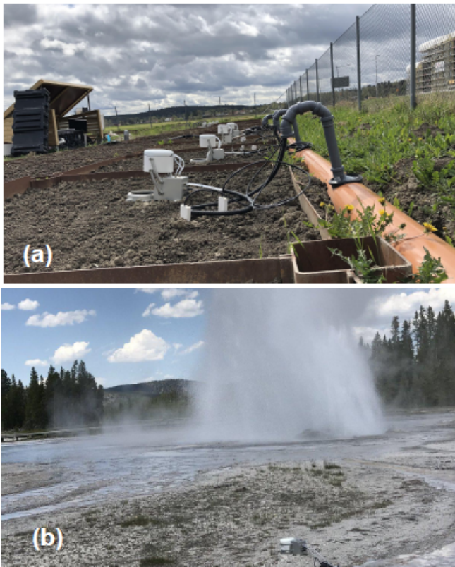
图 1. (a) 在瑞典乌普萨拉市奥尔图纳 (Ultuna) 场地, 将 eosAC 腔室与 Picarro G2201-i 进行耦合 (图片: Muhammad Shahbaz, 圣路易斯大学 (SLU)) (b) 在黄石国家公园雏菊间歇泉附近测量碳同位素 (图片: Moyo Ajayi, 范德堡大学)
